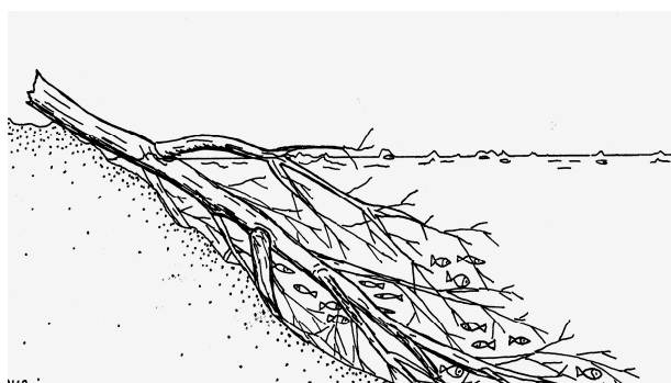
Figuur 7.2 Onderwaterstructuren kunnen worden gecreëerd door bomen langs de oever in het water te leggen of takkenbossen gebundeld in dieper water af te laten zinken.
